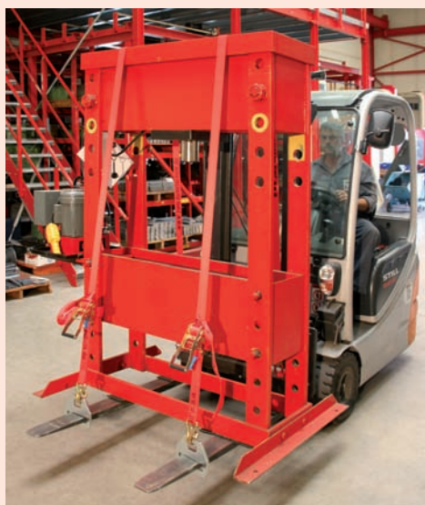
Ladungssicherung mit Gabelklemmen und Spanngurten
